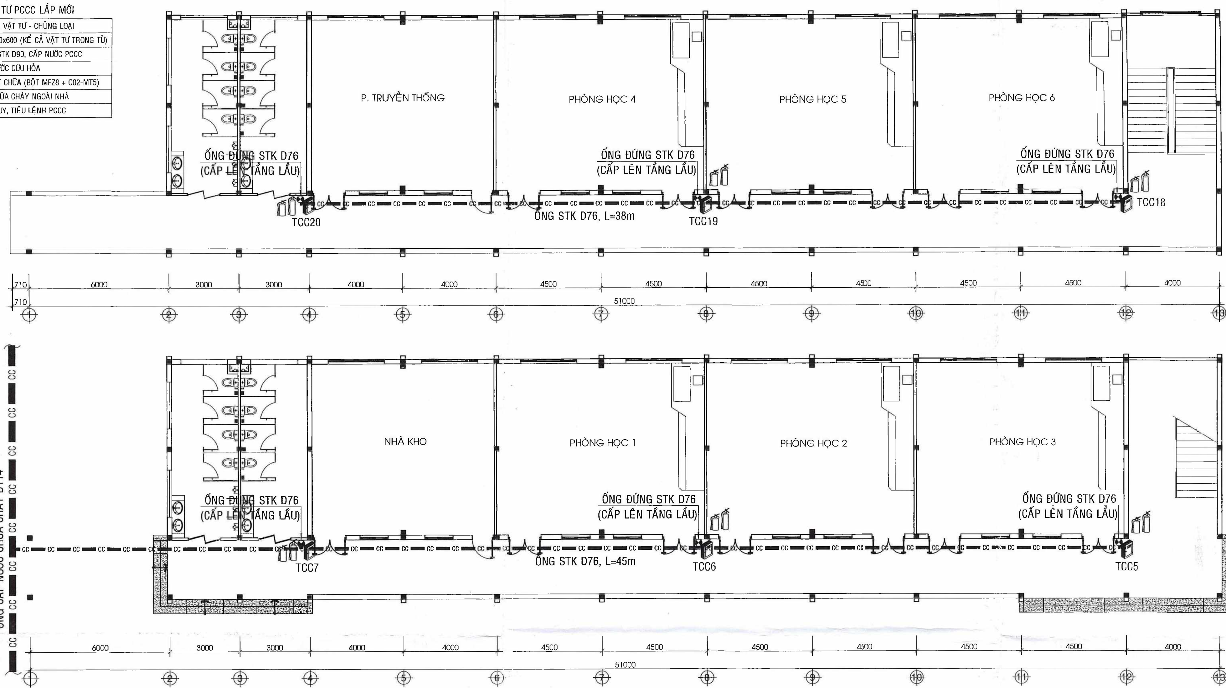
MẶT BẰNG CẤP NƯỚC PCCC TẦNG TRỆT - DÂY 06PH + 02 PCN XÂY MỚI TL:1/100
